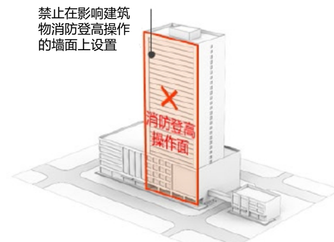
图4-2 不应影响建筑消防登高操作示意图
